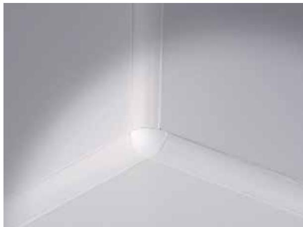
SANITEC ER ist ein Profil aus Kunststoff für innere Kanten nach den hygienischen Anforderungen. Es ist während der Belagsverlegung einzusetzen und für eine genaue Bearbeitung geeignet. Sauberkeit und Hygiene in den inneren Kanten der Wände oder zwischen Wand und Boden werden dank dem besonderen Biegungsradius gewährleistet.
